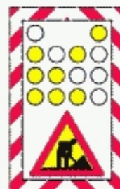
Semnalizarea unui utilaj care se deplasează lucrând
