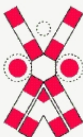
Trecere la nivel cu o cale ferată dublă, fără bariere, prevăzută cu semnale
